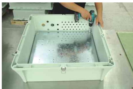
安装底板 Install the base plate
